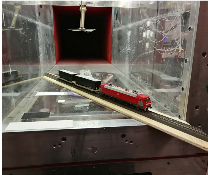
Figur 27 Tog placeret i 60^0 flowvinkel
