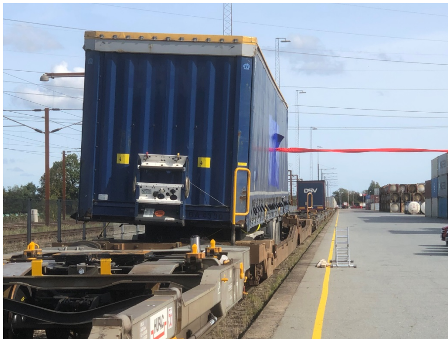
Figure 36 Trækforsøg på trailer
