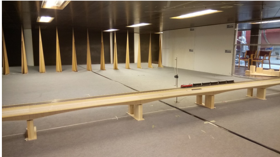
Figur 2 Vindtunnel setup, vestbro med 5 brofag og H0 modeltog, skala 1:87
